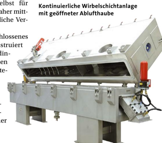
Kontinuierliche Wirbelschichtanlage mit geöffneter Ablufthaube
